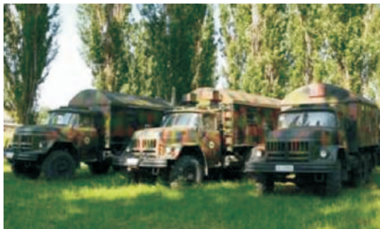
Foto 6: Autostație radioreleu R-404
