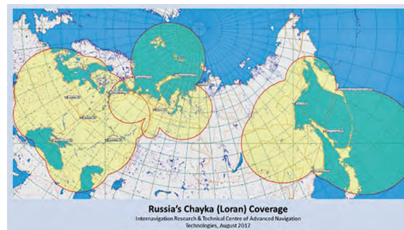
Figura nr. 2: Hartă de acoperire (2017) de la Centrul de Cercetare Internavigație și Centrul Tehnic de Navigație Avansată din Rusia, care arată că sistemul Chayka deservește Europa de Est, vestul Rusiei și aproape toată Marea Neagră (Cozzens, ib.)
