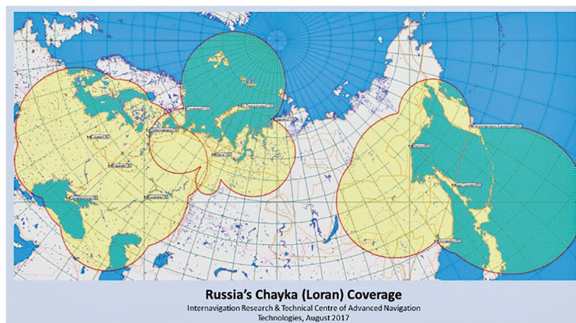
Figura nr. 2: Hartă de acoperire (2017) de la Centrul de Cercetare Internavigație și Centrul Tehnic de Navigație Avansată din Rusia, care arată că sistemul Chayka deservește Europa de Est, vestul Rusiei și aproape toată Marea Neagră (Cozzens, ib.)
