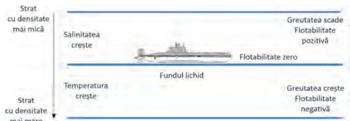
Figura 3: Submarin pe fundul lichid – schiță de principiu (concepția autorului)
