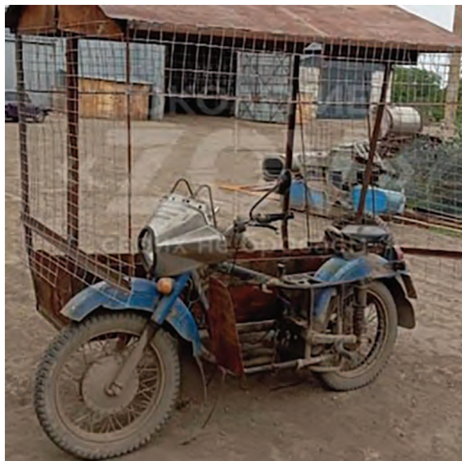
Foto 3: Motocicletă aparținând armatei Federației Ruse, pe care a fost improvisată o cușcă de protecție împotriva dronelor FPV (Telegraph, 2024)
